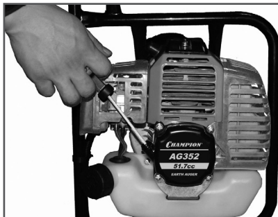
Рис. 7 Свободный ход шнура стартера
