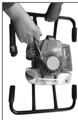
Рис. 9 Свободный ход шнура стартера
