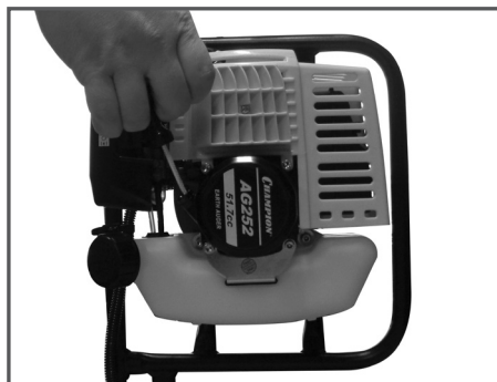
Рис. 7 Свободный ход шнура стартера
