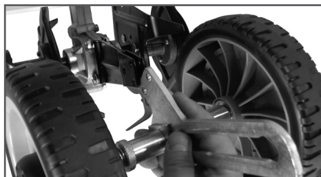
Рис. 6 Установка кронштейна колес
