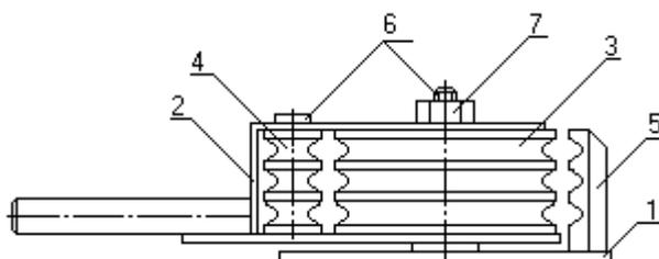
4.2. Для работы трубогиб установить на горизонтальную поверхность и закрепить тремя болтами М12 (в комплект поставки не входят). Корпус 2 подвести к упору 5. Вставить трубу так, чтобы она встала между роликами 3 и 4. После этого поворотом корпуса 2 загнуть трубу на требуемый угол.
