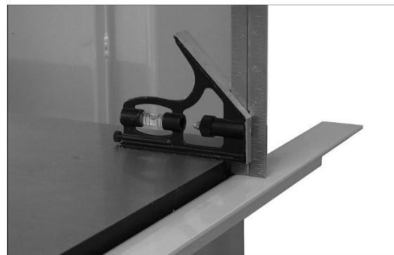
Рис. 5: выравнивание задней направляющей
