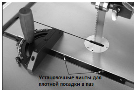
Рис. 34: настройка приспособления для распила под углом
