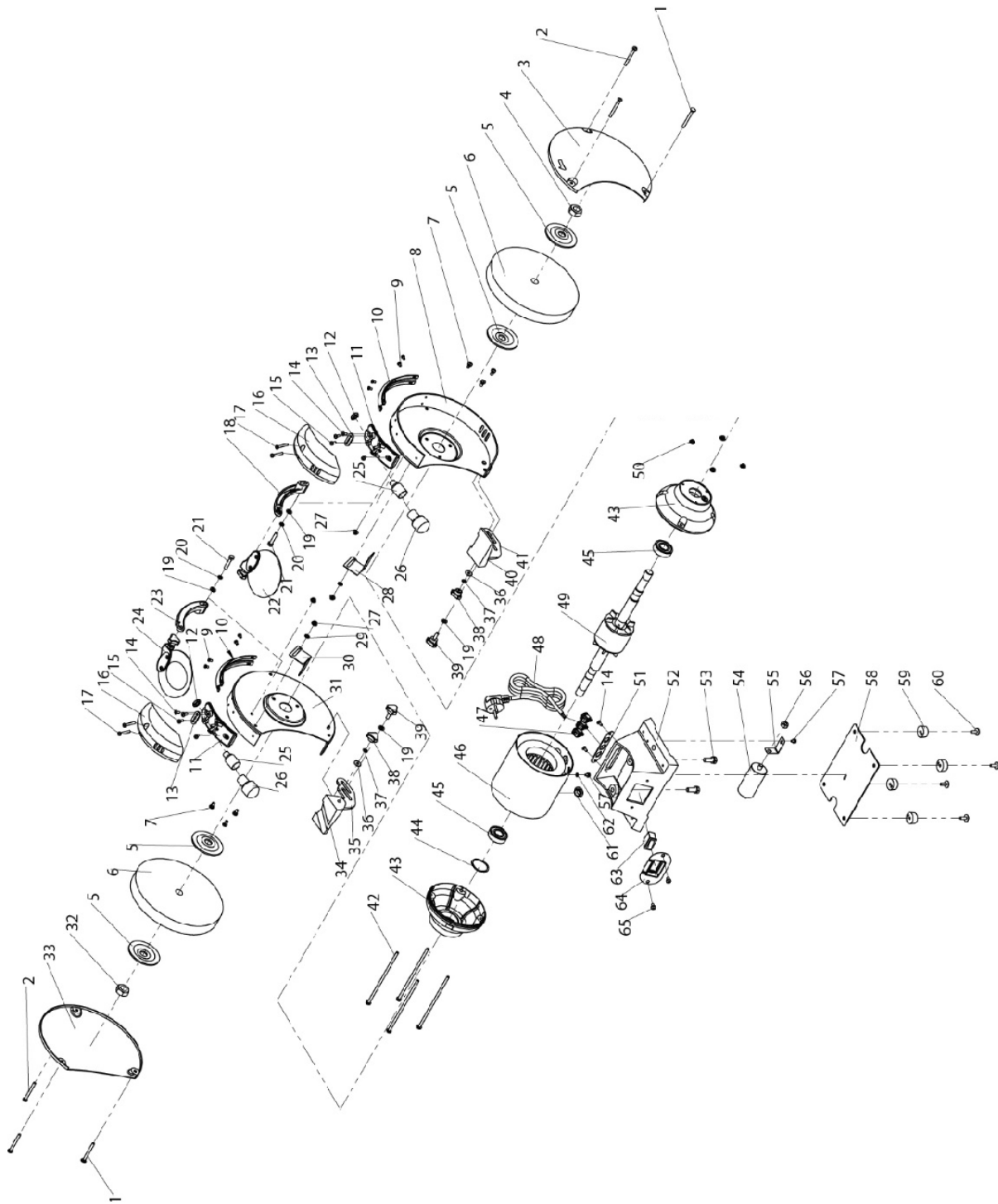
Рисунок 13. Взрыв-схема для модели BELMASH MBG-200M
