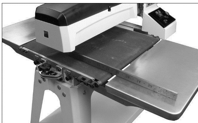
Рис. 6-4: выравнивание удлиняющих столов.
