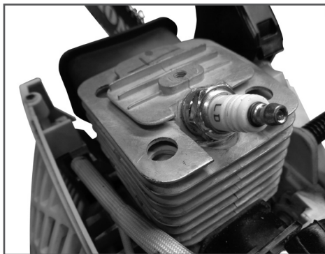
Рис. 29 Охлаждающие ребра цилиндра
