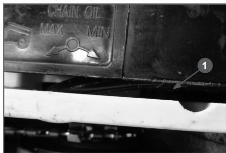
Рис. 8 Винт регулировки подачи масла 1. Винт регулировочный
