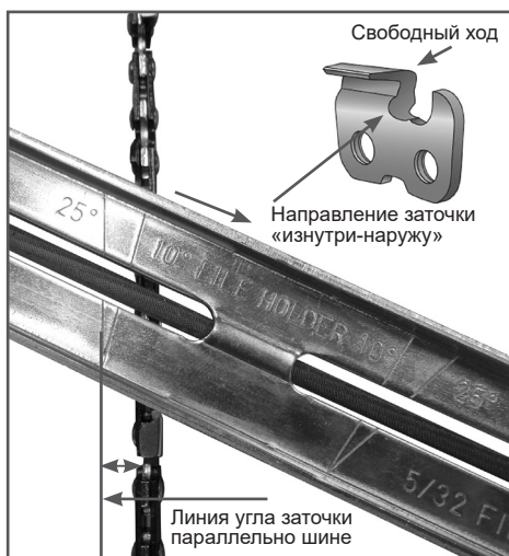
Рис. 23 Расположение линии угла заточки
