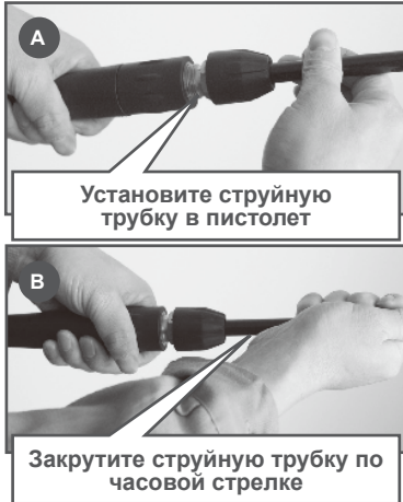
Рис. 5 Установка струйной трубки на пистолет
