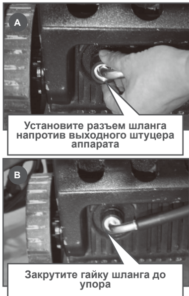
Рис. 4 Подключение шланга высокого давления к аппарату
