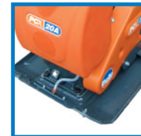
Дельта-образная форма плиты – специально для асфальта
